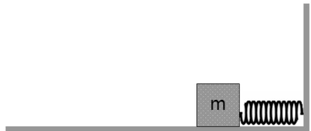
A constante elástica da mola  $k = 1,0 \cdot 10^2$  N/m e seu comprimento está reduzido em 10 cm em relação ao valor original. Permite-se a expansão da mola e verifica-se que o bloco, no instante em que perde o contato com ela, possui uma velocidade de 2 m/s.
