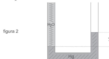
Considere a densidade do mercúrio  $13,6 \text{ g/cm}^3$  e a da água  $1 \text{ g/cm}^3$ . A diferença de nível  $y$  entre a superfície livre do mercúrio no ramo da direita e a superfície de separação entre o mercúrio e a água no ramo da esquerda é
