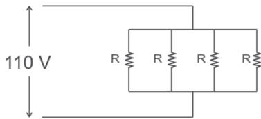
Por necessidade do serviço, esse forno foi transferido para uma ala onde, em qualquer tomada, a tensão é 220 V.
